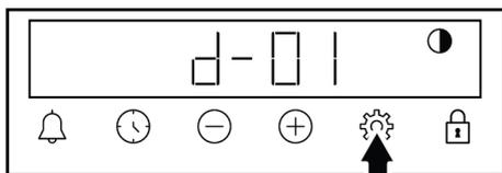
2. Установите желаемую яркость с помощью кнопок  $\oplus/\ominus$ . (**d-01-d-02-d-03**)
