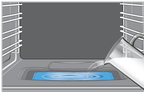
**i** Не используйте дистиллированную и фильтрованную воду. Используйте только производственную воду. Не используйте легко воспламеняющиеся, спиртовые и твердые частицы вместо воды.
