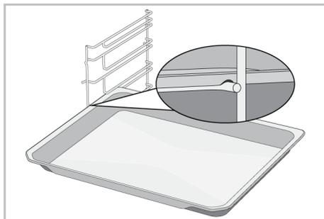
**Правильное размещение решетки и противня на телескопических направляющих-Модели с металлическими и телескопическими направляющими**
