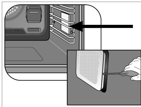
3. Поднимите защитную стеклянную крышку лампы с помощью отвертки. Сначала открутите винт, если в вашем изделии есть винт на квадратной лампе.
