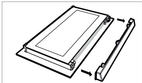
3. Как проиллюстрировано на рисунке, осторожно поднимите самое внутреннее стекло (1) в направлении «А», а затем снимите его, потянув в направлении «В».
